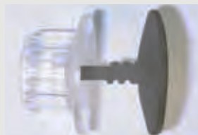
Klebelemente für die Isolierfolie Der Fußteil dieser zweiteiligen Kunststoffelemente wird einmalig an die Sprossen Ihres Gewächshauses geklebt. Die Folie wird aufgesteckt und durch den Schraubdeckel sicher gehalten, ohne Kleber (auch für Fremdfabrikate).
