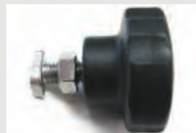
Befestigungselemente / Rändelmutter Folienhalter mit Patent-Hammerkopfschraube und Mutter aus Edelstahl. Folie wird aufgesteckt und durch die Rändelmutter gehalten. Ohne zu kleben (eine einfache Lösung), auch für Fremdfabrikate mit passenden Profilenuten.
