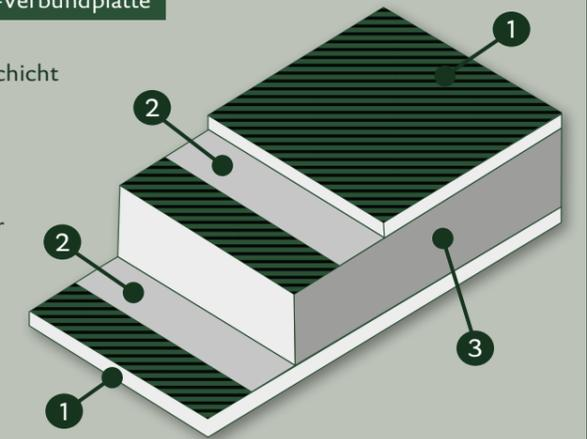
platten außerdem eine hohe UV-Beständigkeit auf und halten Temperaturen von minus 50°C bis plus 80°C aus. Somit sind sie überall einsetzbar und äußerst witterungsbeständig. Daher verwenden wir das Material nicht nur bei Carportsystemen, sondern auch für unsere Geräteräume und Aluminium-Hochbeete.
